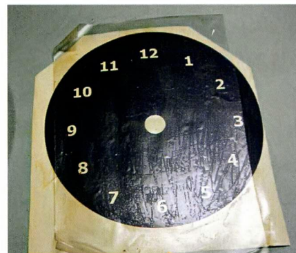
Для переноса трафарета монтажную плёнку наклеивают на корпус...
